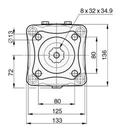
Shaft: DIN 5462 / ISO14 Mounting Flange: ISO 7653-D
