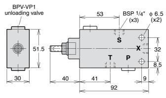
Fig. 5. BPV-VP1 unloading valve.
